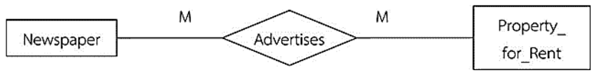
ภาพที่ 2.3 ความสัมพันธ์แบบกลุ่มต่อกลุ่ม (Many-to-Many Relationship)
